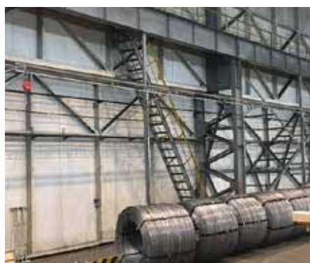
Металлургическое производство. Участок погрузки готовой продукции. Горизонтальная рельсовая анкерная линия Мультирейл. Установлена на складных шарнирных г-образных опорах
