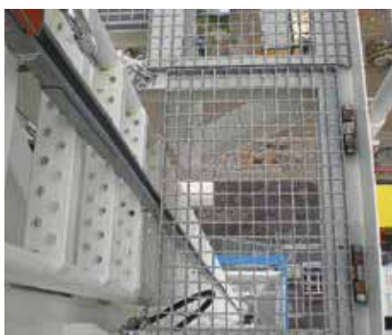
Буровая платформа. Лестница с рабочей площадкой. Вертикальная рельсовая анкерная линия Глайдлок
